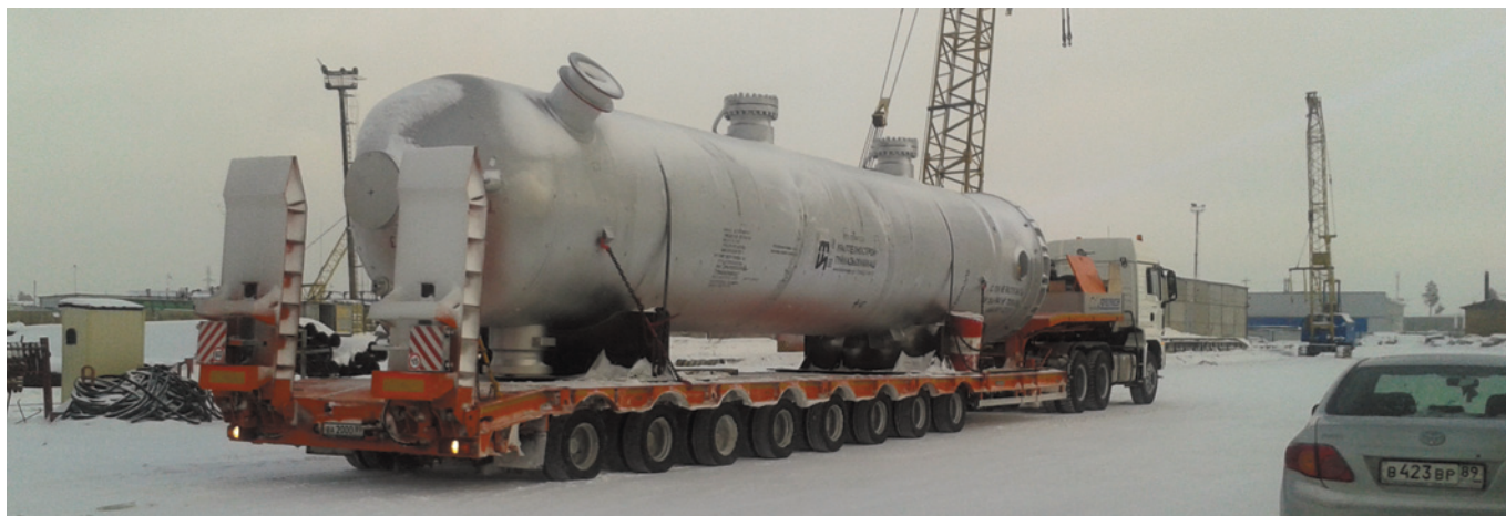
Рис. 4. Транспортировка укомплектованного адсорбера для блока осушки на промышленную площадку Вынгапуровского ГПЗ
