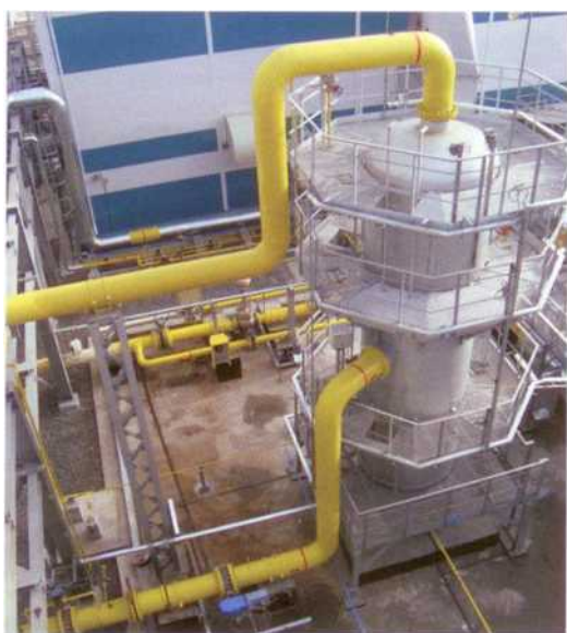
Рис. 5. Сепаратор E1 (Губкинский ГПК): а - внешний вид; б - 3D модель
